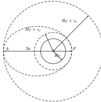
L'énergie sur l'orbite haute étant supérieure à celle sur l'orbite de transfert, on doit de nouveau augmenter la vitesse du chasseur à l'apogée pour le placer sur l'orbite circulaire haute. On adapte le calcul énergétique précédent. On obtient, en utilisant la vitesse  $v_s = \sqrt{\frac{\mathcal{G}m_T}{R_T + z_s}}$  la vitesse sur l'orbite circulaire de la station :
